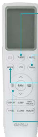
Funzione **TURBO**. Aumenta la capacità di raffreddamento o riscaldamento per ottenere la temperatura desiderata in modo rapido.
